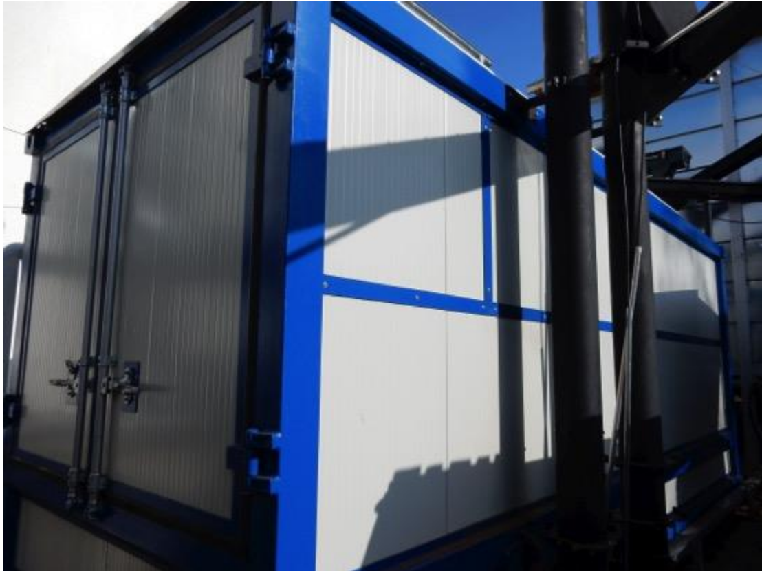
Der neue Schubbodentrockner für die Spanner Re 2 Holz-Kraft-Anlage
